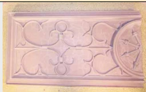
**Gussform:** Der Eisenguss erfolgt meist nach dem sogenannten Sandgussverfahren.
